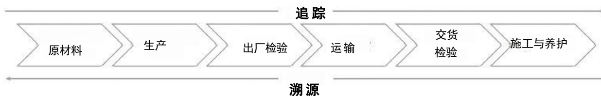
图2 预拌混凝土产品质量追溯流程示意图
